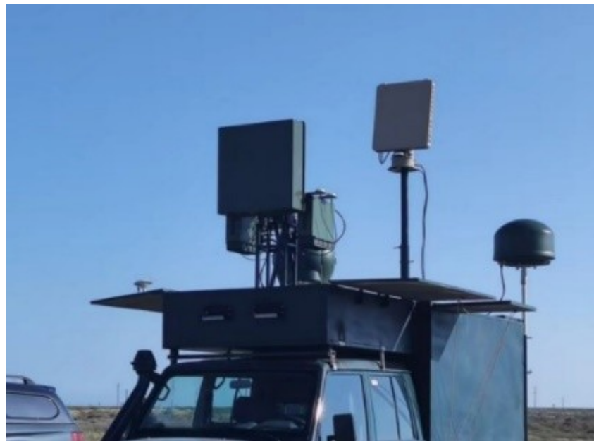
Мобильно: автомобильное шасси в составе комплекса (радар + ОЭС + спектроанализ + подавление)
